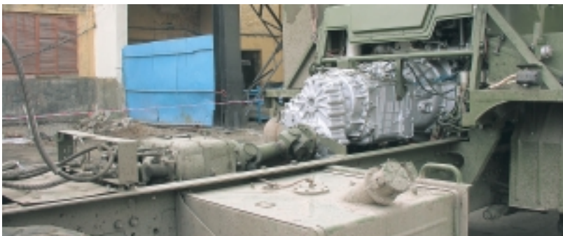
Коробка передач ЯМЗ-2394 с несомным расположением фланца выходного вала специально создавалась для семейства БАЗ-6402
