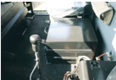
На месте среднего сиденья размещен контейнер со специальным оборудованием
