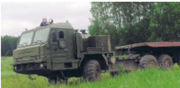
BAZ-6402-013 оснащен люком в крыше и откидывающимися форточками в боковых окнах
