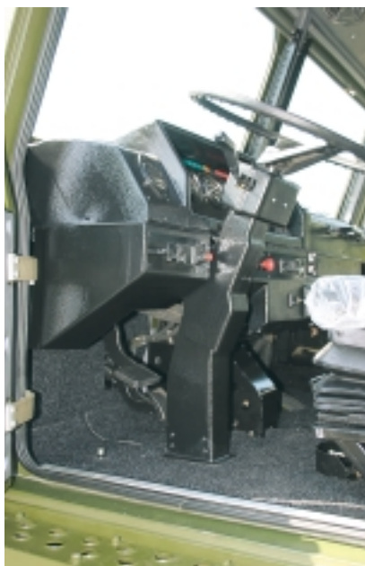
Рулевая колонка регулируется по углу наклона
