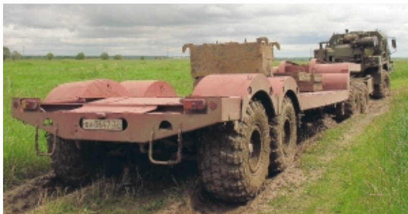
Двухосный полуприцеп снабдили такими же широкопрофильными шинами, как и тягач
