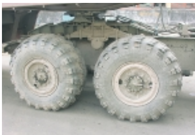
Сзади установлена комбинированная торсионно-рессорная подвеска
